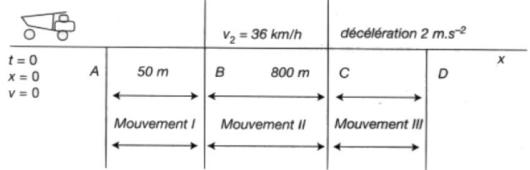
Pour les 3 mouvements on impose le point A comme origine des temps (t = 0) et des espaces
