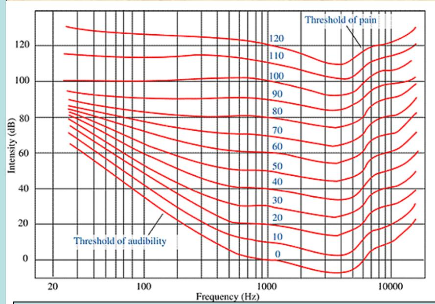
**Diagramme** (dit également de **Fletcher et Munson**, 1933) qui, dans un espace à deux dimensions (fréquence en Hz portée en abscisse et niveau de pression acoustique en dB portée en ordonnée) indique les courbes d'égalité de sensation sonore.
