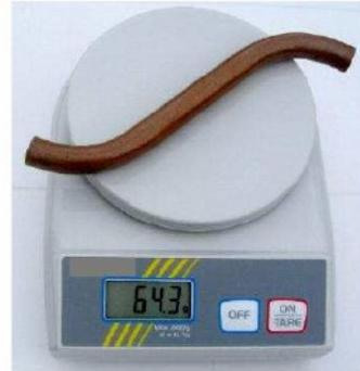
La balance mesure la masse  $m=64,3\text{g} = 64,3 \times 10^{-3} \text{ kg}$
