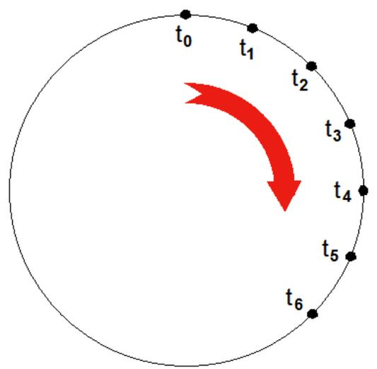
Lorsqu'un point se déplace à vitesse constante en suivant une trajectoire circulaire, alors le mouvement est dit : "circulaire uniforme".
